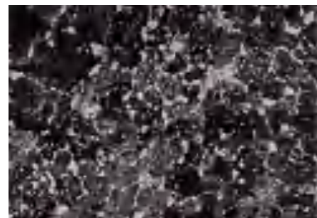
500× 细珠光体 + 球状石墨 + 碳化物 500× Fine pearlite + Spheroidal graphite + Carbides
