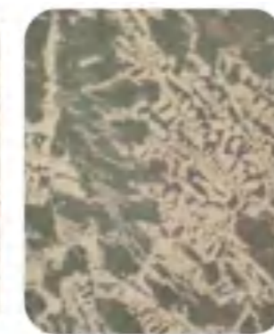
100× 高镍离心轧辊 金相组织 100× High nickel centrifugal roll metallographic structure
