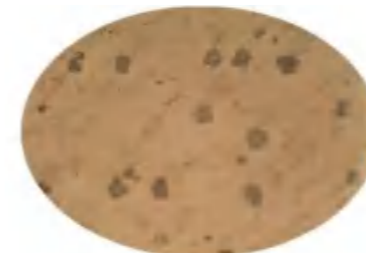
100× 珠光体 + 球状石墨 + 碳化物 100× Pearlite + Spheroidal Graphite + Carbide
