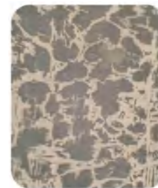
100× 贝氏体轧辊 金相组织 100× Bainite roll metallographic structure
