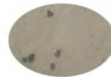
100× 高镍离心轧辊 + 球化石墨 + 碳化物 100× High nickel centrifugal roll + Spheroidized graphite + Carbide
