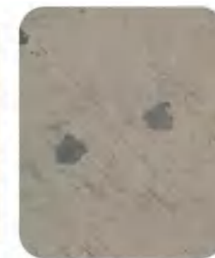
100× 贝氏体轧辊 + 球化石墨 + 碳化物 100× Bainite roll + Spheroidal graphite + Carbide
