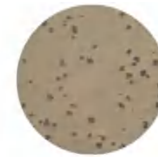
100× 半钢轧辊 金相组织 100× Adamite roll metallographic structure
