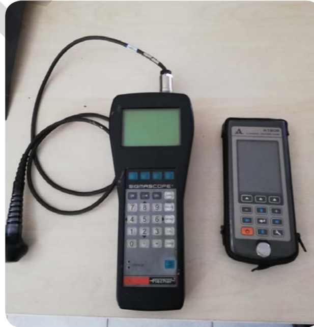
Ultrasonic Kalınlık Ölçme ve Elektrik iletkenliği Ölçme Cihazı Ultrasonic Thickness Measuring and Electrical Conductivity Measuring Device
