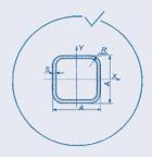
Профильные трубы квадратного сечения от 150х150 до 200х200 мм
