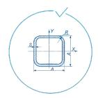
квадратного сечения типоразмеров от 15х15 до 200х200 мм
